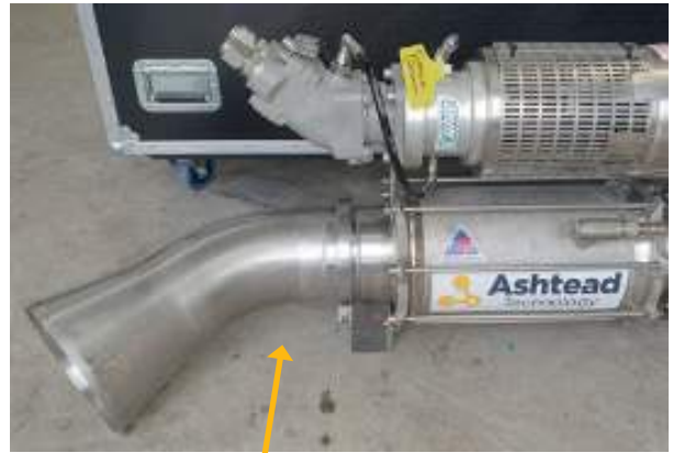
旋转放置带管夹的排气锥弯管,以适合安装。
