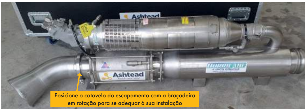
Posicione o escapamento em rotação para se adequar à sua instalação
