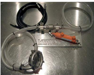
Jateador de água opcional detalhado abaixo: Utiliza água retirada da saída da bomba de água e mostrada em testes que não afeta o desempenho de sucção da draga. Incluído no kit: cabeça do jateador deslizante vai na extremidade da entrada de sucção, válvula de desvio, mangueiras hidráulicas.
