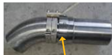
Articulação giratória. Remova os parafusos M8 para desmontar. NÃO monte com graxa. Monte apenas seco.
