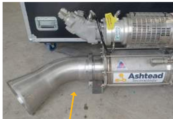
Posicione o escapamento em rotação para se adequar à sua instalação
