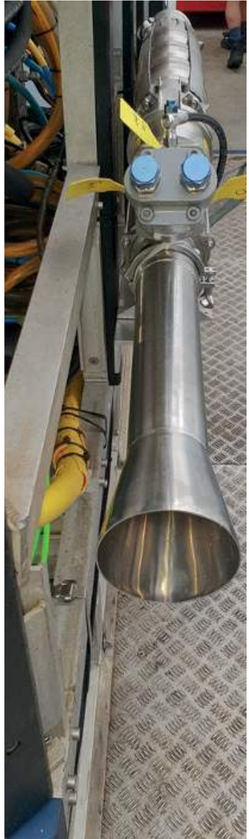
Jateador de água opcional detalhado abaixo: Utiliza água retirada da saída da bomba de água e mostrada em testes que não afeta o desempenho de sucção da draga. Incluído no kit: cabeça do jateador deslizante vai na extremidade da entrada de sucção, válvula de desvio, mangueiras hidráulicas.
