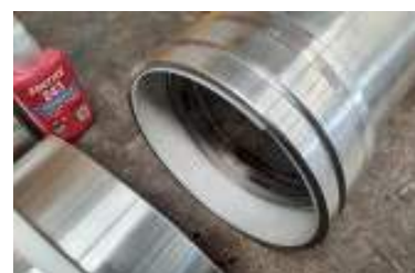
Articulação giratória. Remova os parafusos M8 para desmontar. NÃO monte com graxa. Monte apenas seco.
