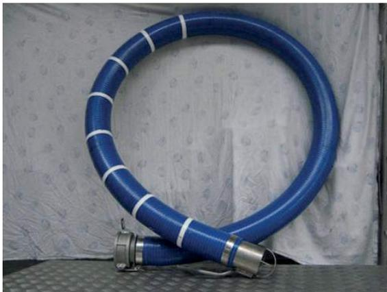
Mangueira de entrada com cabeçote de sucção e alça de manipulador de ROV.
