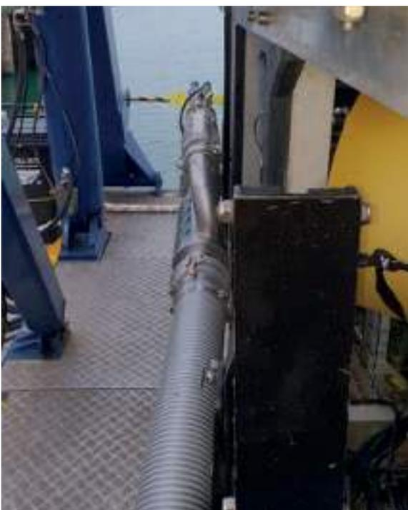
Draga mostrada montada no ROV usando o ângulo de alumínio fornecido. Perfure o ângulo fornecido para ficar adequado.
