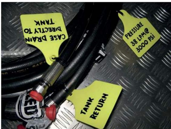
Mangueira hidráulica com marcações claras para facilitar a mobilização. As mangueiras de pressão e retorno têm classificação de pressão idêntica para evitar qualquer chance de falha por montagem incorreta. Certifique-se de que o ROV tem capacidade e fornece um mínimo de 75 lpm (mínimo de 19 gpm) mínimo de 165 bar (mínimo de 3000 psi) antes de instalar o kit de dragagem.
