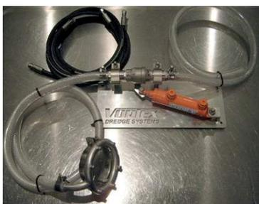
Jateador de água opcional detalhado abaixo: Utiliza água retirada da saída da bomba de água e mostrada em testes que não afeta o desempenho de sucção da draga. Incluído no kit: cabeça do jateador deslizante vai na extremidade da entrada de sucção, válvula de desvio, mangueiras hidráulicas.
